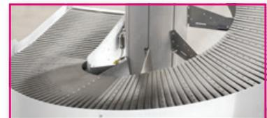
**Tabla de banda patentada:** Nuestro innovador diseño de cadena y tablilla permite un funcionamiento de baja fricción sin movimientos de deslizamiento ni bandas de desgaste. Así se consigue una capacidad de carga total de hasta 1.630 kg y puede arrancar y detenerse totalmente cargada.
