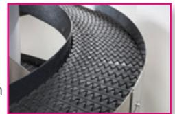
**Micro Pitch:** En la entrada/salida de la NT puede montarse un transportador opcional accionado por esclavo con un diseño de punta sobrepuesta para garantizar una transferencia fiable de los artículos más pequeños.
